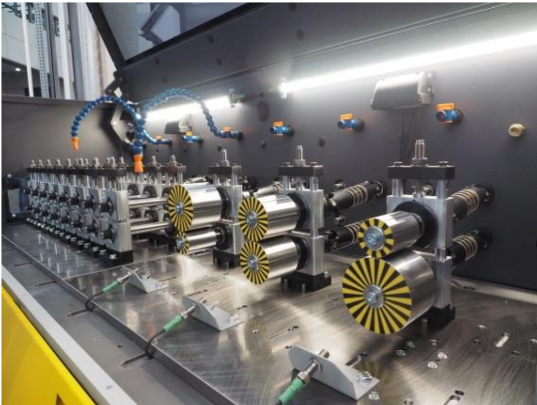
Flexibles Übersetzungsverhältnis zwischen Ober- und Unterwelle (Foto: PROFILMETALL).
